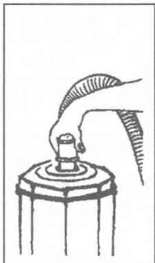
Asegúrese de que la tapa se enrosca y se bloquea en la aspiradora. Tome la manguera de la aspiradora y empuje en la abertura redonda en la parte superior de la tapa.
